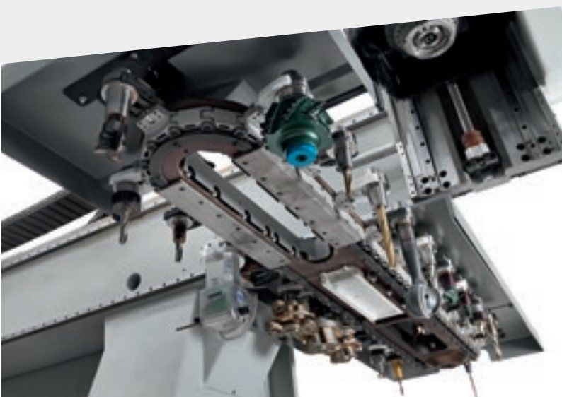
Depósito com corrente de 33 posições
