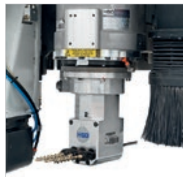
O grupo multifuncional , com posicionamento contínuo em 360° controlado por CN, pode receber agregados para a execução de usinagens específicas (fenda para ferragens, alojamento para dobradiças, perfuração horizontal profunda, usinagem de topo, etc.).
