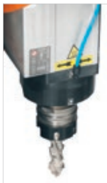
Motor vertical fixo para usinagens complementares de fresagem (abertura, corte de juntas, etc.).
